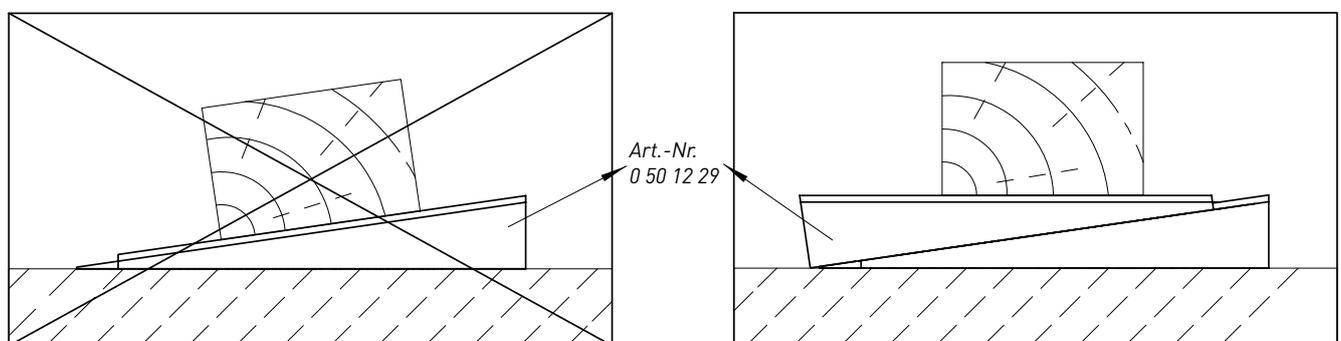
Unebenheiten einer Hauswand können mit Montagekeilen ausgeglichen werden. Verdrehungen der Latten sind dabei zu vermeiden. Wenn Fassadenprofile auf verdrehte oder unebene Unterkonstruktionen montiert werden, können Verwölbungen entstehen.
