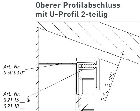
Auch die Zubehörprofile unterliegen bei Temperaturerhöhungen einer Wärmeausdehnung. Es ist unbedingt darauf zu achten, dass an den Profilenden zu anderen feststehenden Bauteilen genügend Raum für die Ausdehnung vorhanden ist. Die Oberteile von senkrecht montierten 2-teiligen Zubehörprofilen sind gegen Abrutschen im oberen Bereich, z. B. mit Montagekleber, Silikon oder Schrauben, zu fixieren.
