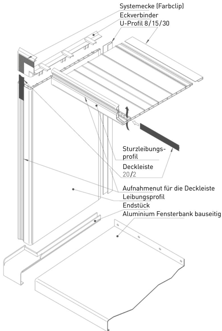
Für die Entlüftung der Fassadenfläche unter der Fensterbank muss zwischen der Oberkante des vinyPlus Quattro Profils und der Unterkante der Fensterbank ein Spalt von mindestens 5mm belassen werden. Um Verschmutzungen der Fassadenoberfläche zu vermeiden, empfehlen wir einen Fensterbanküberstand von 3 – 4 cm und den Einbau von Fensterbankendstücken (Art.-Nr.: 0 63 60 \_\_).
