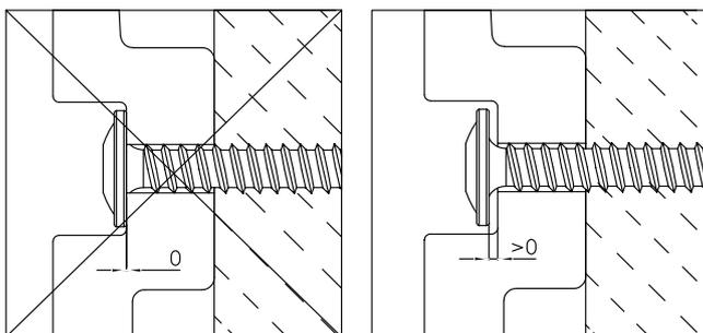
Les vis de fixation doivent être positionnées au milieu du trou oblong et ne doivent pas être serrées trop profondément. Il faut éviter de créer une tension ou de brider la lame de bardage.
