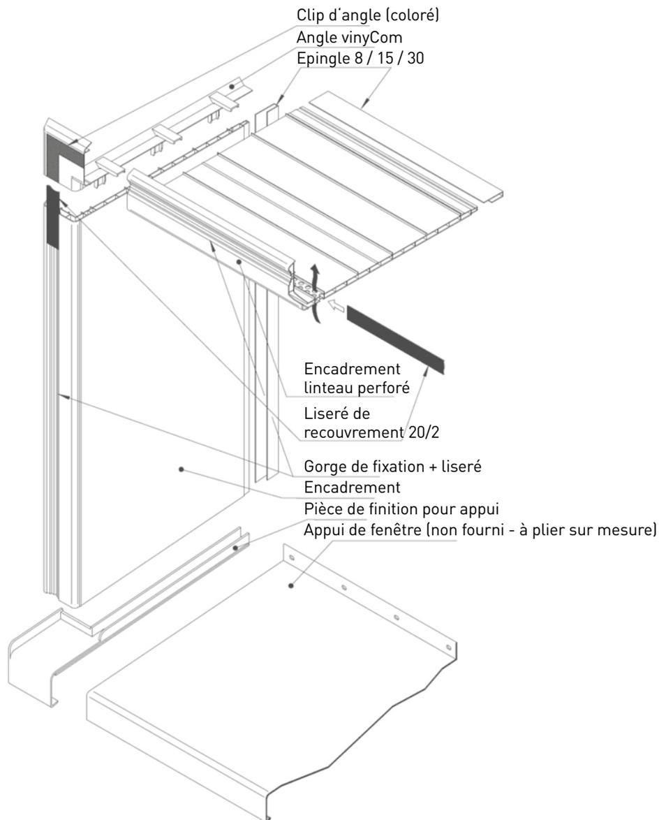
Pour ventiler le bardage placé sous l'appui de fenêtre, un espace d'au moins 5 mm doit être laissé entre le bord supérieur bardage vinyPlus et le bord inférieur de l'appui de fenêtre. La reprise de ventilation sous linteau doit être également assurée. Afin d'éviter tout encrassement du bardage, nous recommandons un débord d'appui d'au moins 3 à 4 cm et le montage Pièces de Finition pour appuis de fenêtre (Art N° 0 63 60\_\_)
