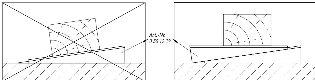
Des défauts de planéité d'un mur peuvent être corrigés grâce aux cales pour ossature. Il faut veiller à éviter une torsion de l'ossature. La pose du bardage sur une ossature mal réglée peut conduire à des déformations de celui-ci.
