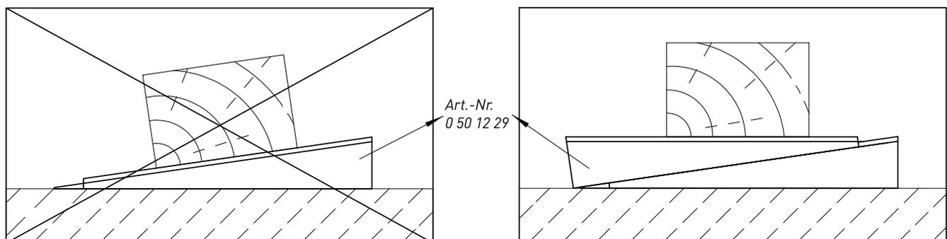
Unebenheiten einer Hauswand können mit Montagekeilen ausgeglichen werden. Verdrehungen der Latten sind dabei zu vermeiden. Wenn Fassadenprofile auf verdrehte oder unebene Unterkonstruktionen montiert werden, können Verwölbungen entstehen.
