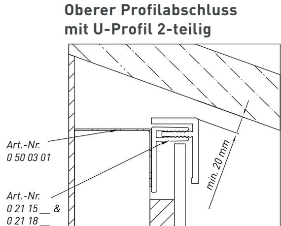
Auch die Zubehörprofile unterliegen bei Temperaturerhöhungen einer Wärmeausdehnung. Es ist unbedingt darauf zu achten, dass an den Profilenden zu anderen feststehenden Bauteilen genügend Raum für die Ausdehnung vorhanden ist. Die Oberteile von senkrecht montierten 2-teiligen Zubehörprofilen sind gegen Abrutschen im oberen Bereich, z. B. mit Montagekleber oder Schrauben, zu fixieren.
